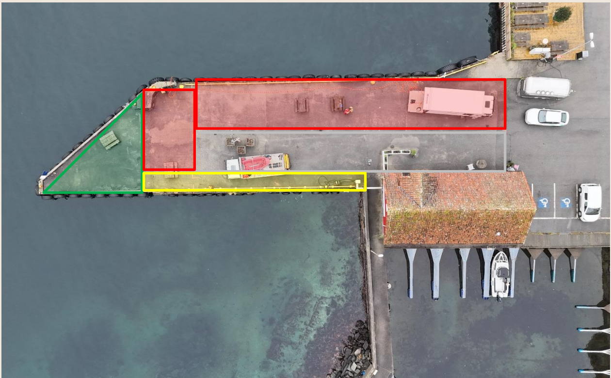
Figur 5: Oversikt over tilstand dekke. Rød tilstand, underkant armering er rustet vekk. Grønt – god tilstand. Grå – Ukjent tilstand hviler mest sannsynlig på gammel steinkai, ikke inspisert i underkant. Gul tilstand, mye korrosjon i underkantarmering.
